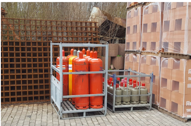
Abb. 27 Lagerung von Gasen incl. Transportgerät
